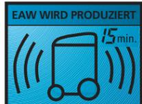
**Vorbereitung des sauren elektrolysierten Wassers (EAW):** Nach Zugabe einer 0,1%igen sterilen NaCl-Lösung, startet das CleanTop® WM-S-System automatisch mit der Herstellung des Desinfektionsmittels EAW. Je nach Wasserqualität dauert dieser Vorgang 15-25 Minuten. Eine einmal zubereitete Ladung erlaubt bis zu 20 Desinfektionszyklen.
